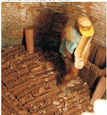
Desencañando o forno nunha fornada de tella.
